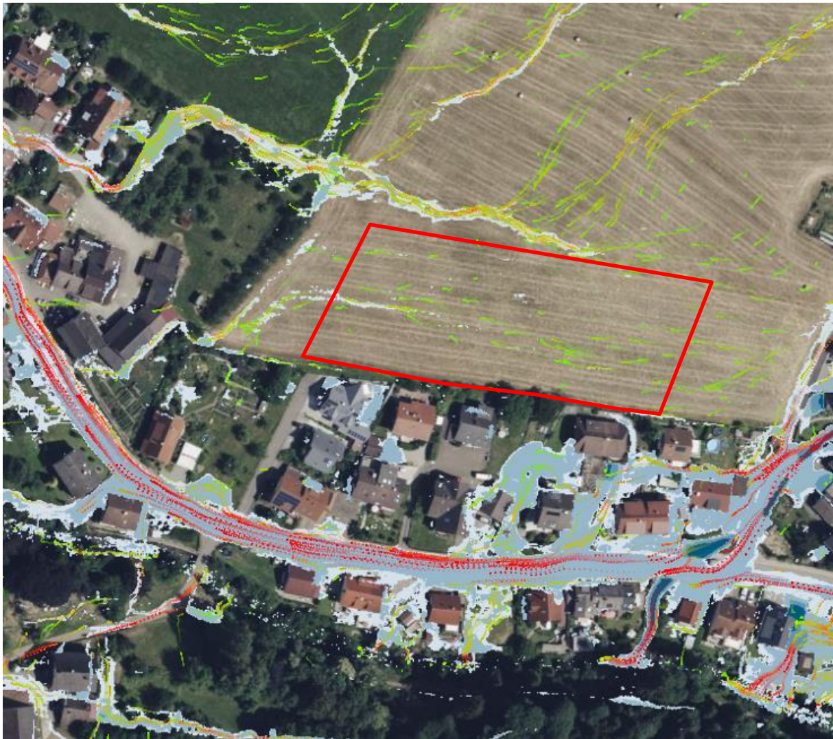
Abbildung 1-2: Ergebnisse Starkregenberechnung (Vorsimulation) für das außergewöhnliche Szenario im Bereich des geplanten Baugebiets (Quelle: Hydrotec)
